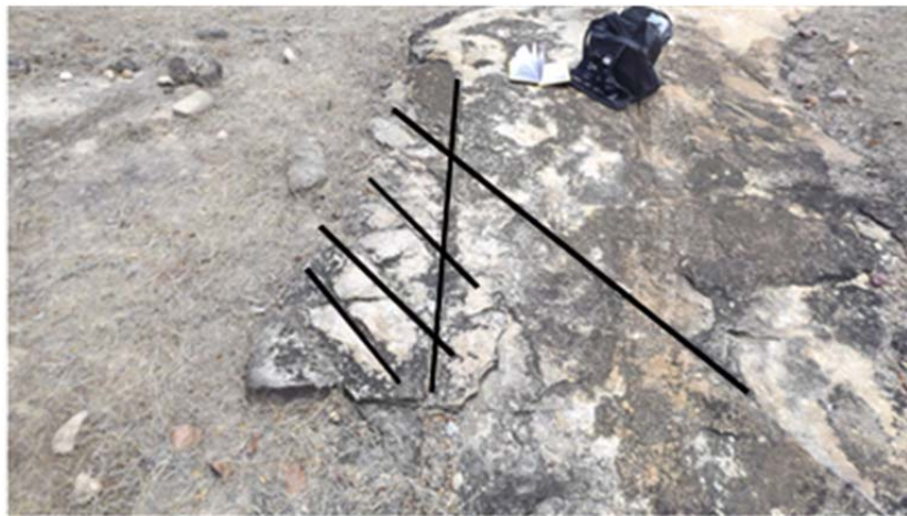
Figura 2.30 - Lajedos de granito estaca 25 - rocha maciça exibindo fraturas nas direções 300az e 270az.
