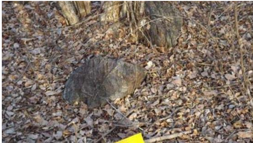
Figura 2.31 - Blocos de anfibólitos e calcissilicáticas, com veios de quartzo cortando a estrutura maciça da rocha. Estaca 57.
