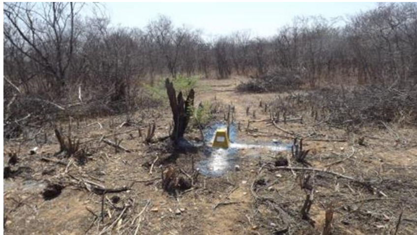
Figura 2.28 - Marco na ombreira direita, estaca 0, início do eixo.
